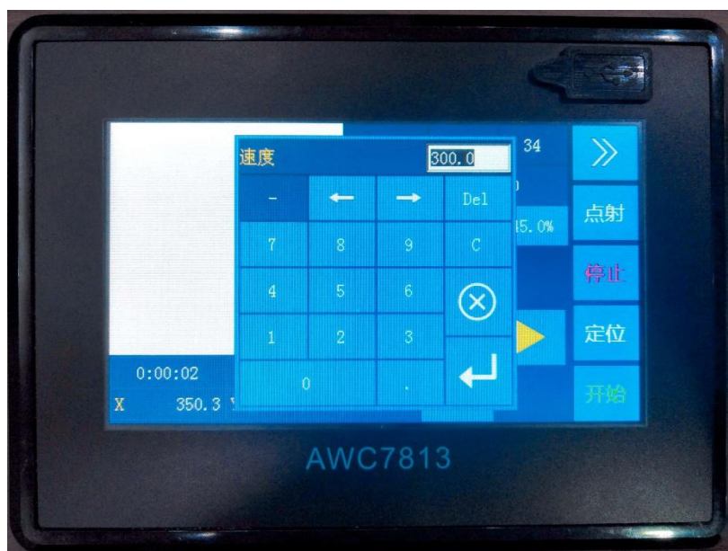
图 3-9-2 修改正在加工的文件的速度
