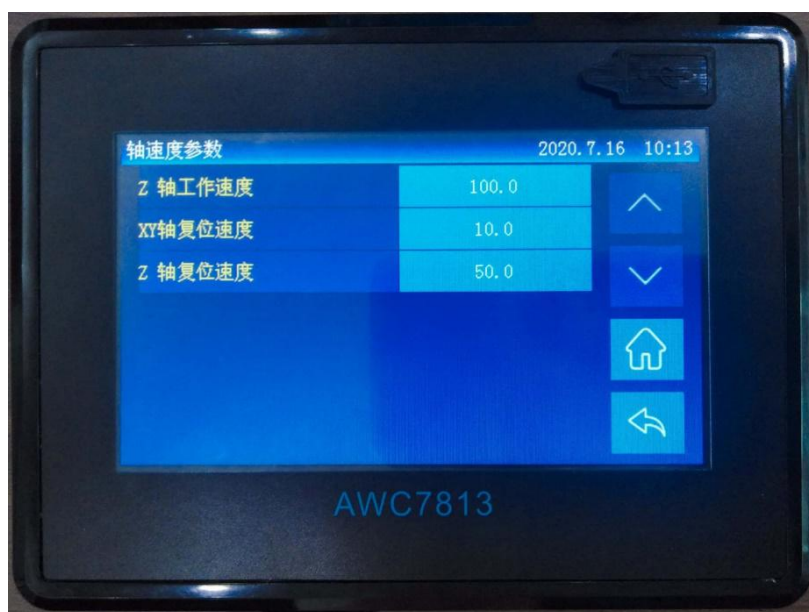
图 3-15-3 轴速度参数设置
