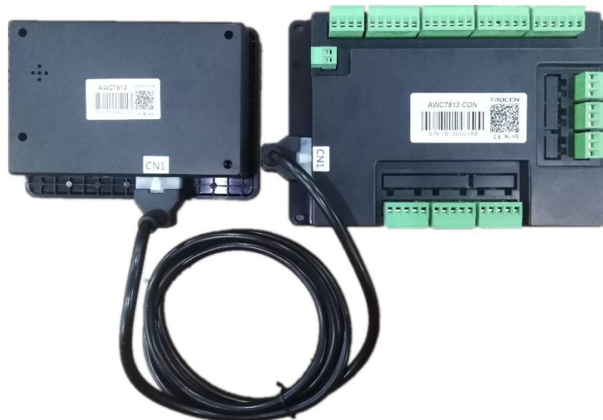
图 2-3-4 面板与接线板的连接端口
