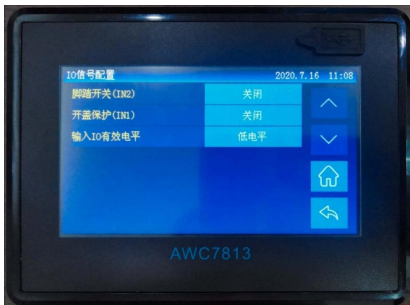
图 3-16-3 IO 信号配置
