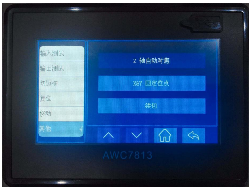
图 3-25-1 Z 轴自动对焦无效
