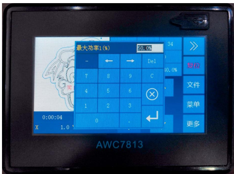
图 3-10-1-1 修改点射最大功率
