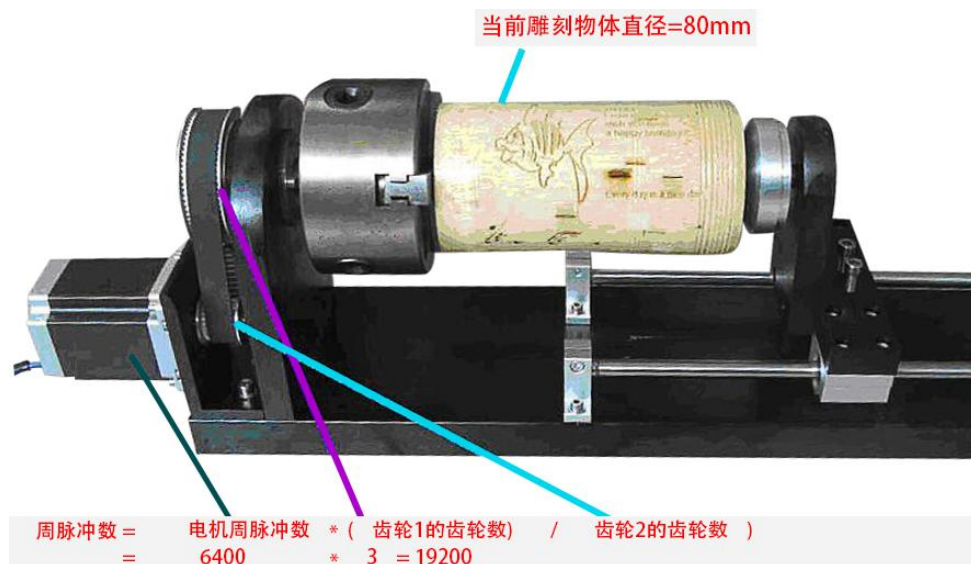
图 3-15-4-3 旋转雕刻切割示例图—夹具式
