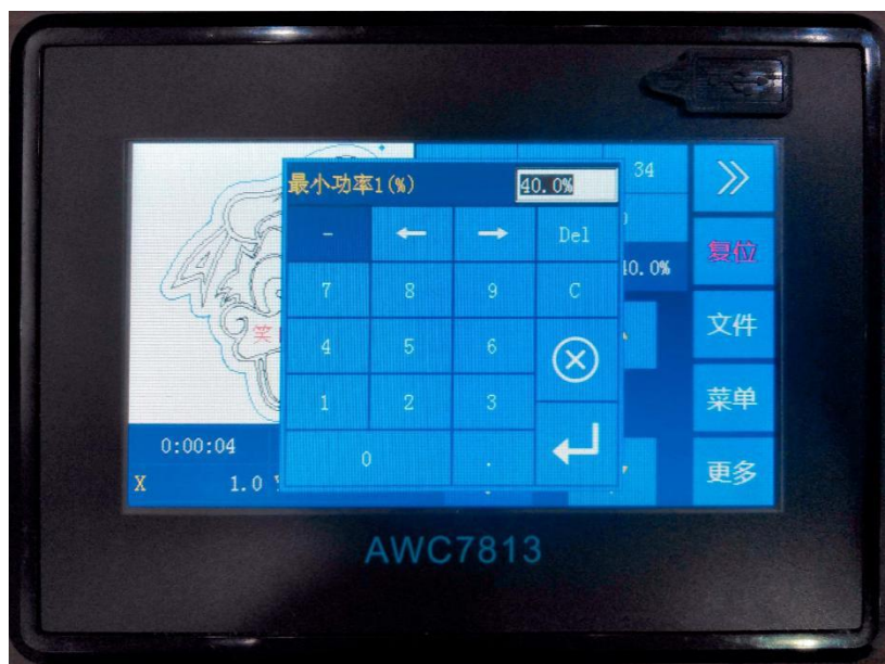
图 3-10-1-2 修改点射最小功率
