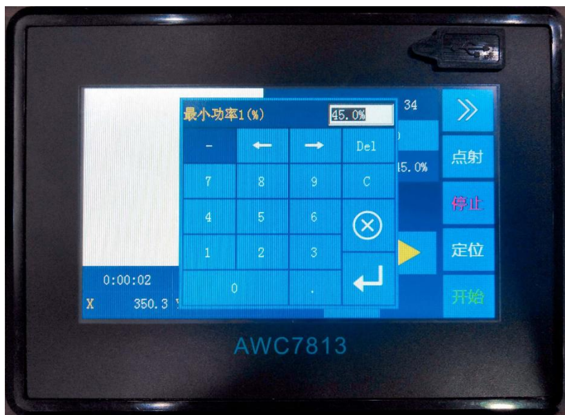
图 3-10-2-2 修改正在加工的文件的最小功率
