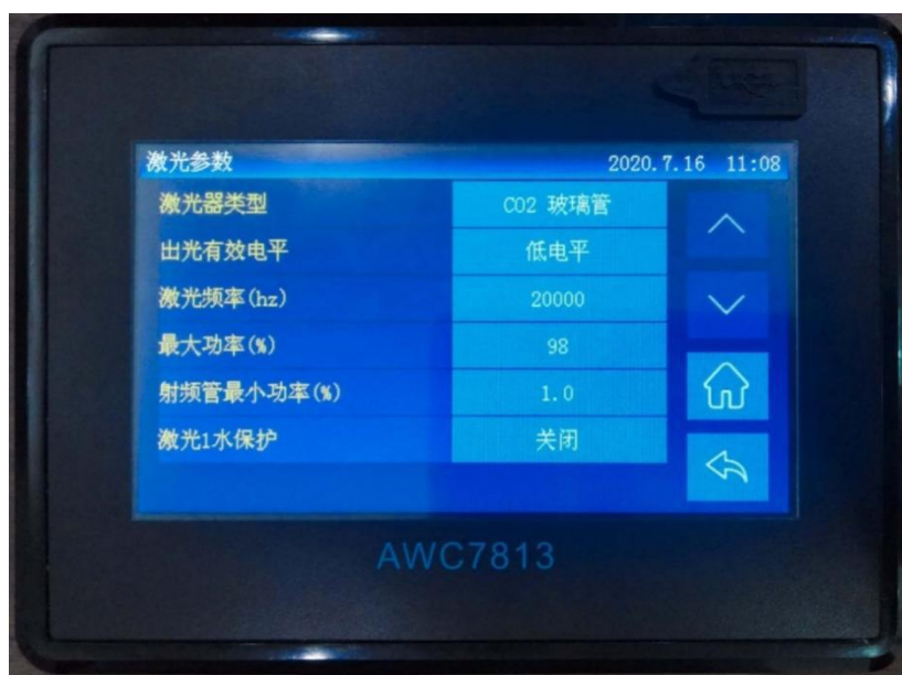
图 3-16-2 激光参数设置
