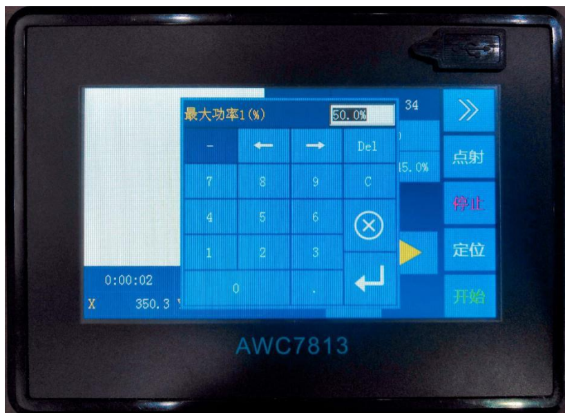
图 3-10-2-1 修改正在加工的文件的最大功率
