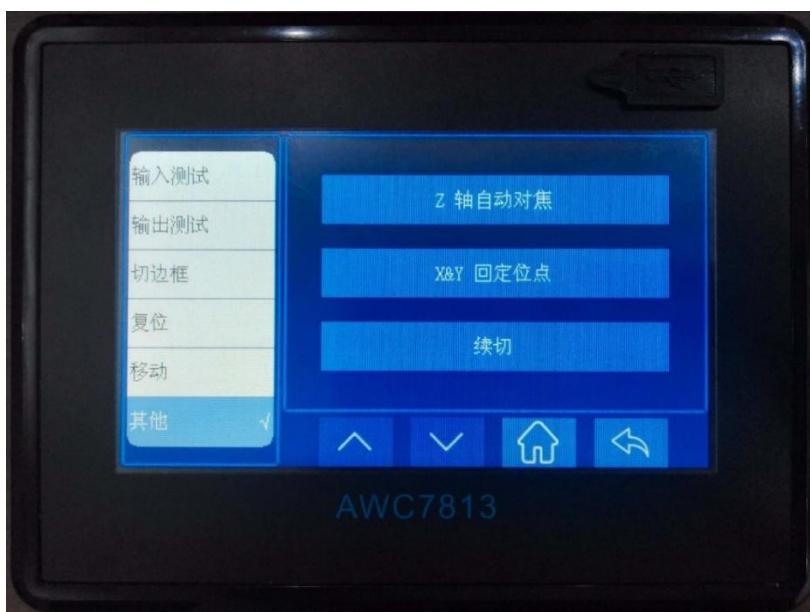
图 3-25 Z 轴自动对焦、回定位点和续切
